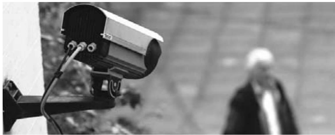
Herkömmliche Sicherheitskameras, wie auf diesem Foto, zeichnen nur Bilder auf. Sogenannte smarte Kameras können darüber hinaus beispielsweise Personen anhand ihres Umrisses identifizieren.
